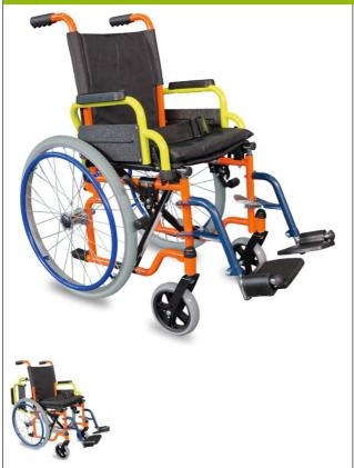
Ce fauteuil roulant manuel est destiné aux enfants. Entièrement pliable, il bénéficie d'accoudoirs relevables, d'une assise fixe ainsi que de repose-pieds rabattables. Côté roues, celle de l'arrière de 51 cm (20') de diamètre ont une main courante ainsi que des freins. Les roues directionnelles de l'avant sont plus petites avec leur 15 cm de diamètre. Une ceinture est intégrée afin d'assurer un meilleur maintien de l'utilisateur.
